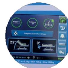
Alarme d'angle d'inclinaison du relèvement buste
