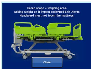
Зона и части кровати, учитываемые при взвешивании, отображаются на экране зеленым.
