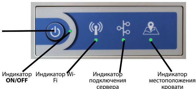
**i** Модуль MCW оснащены только кровати Hill-Rom® 900 Accella™ модели CS900B41XXXXX, CS900B4FXXXXXX и CS900B4GXXXXX.
